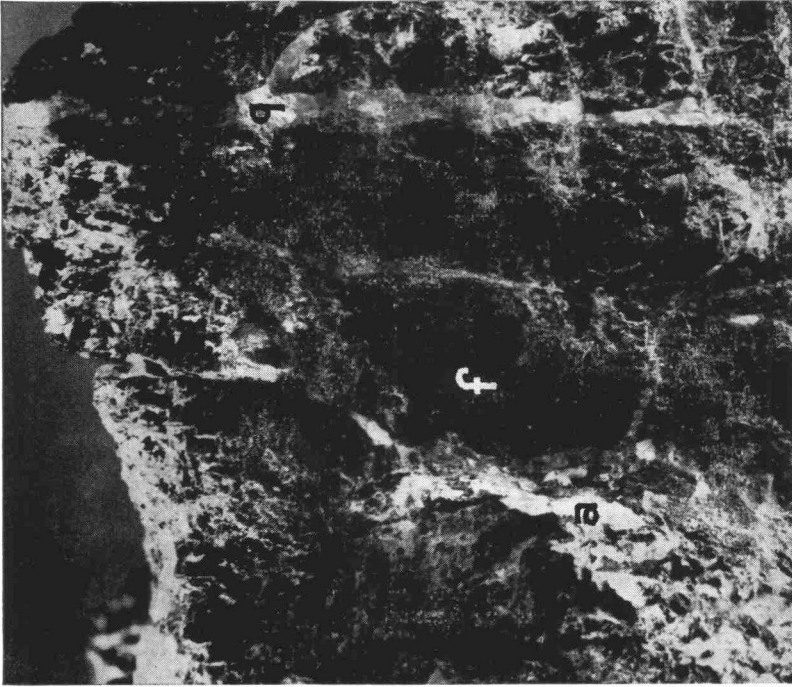
PHOTO 8. — Aspect caverneux du minéral de ferberite dans les parties intérieures des cristaux de reinite. (f) ferberite, (a) anthoïnite, (q) quartz. Mine de M. MIERGE, Niakabingu, Ruanda. (Photo Y. CHARLIER, Bukavu, 1957).
