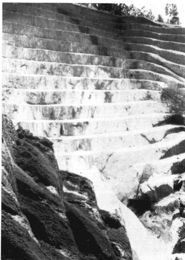
Photographie 16. — Rwanda, Bijojo. Pegmatite albitisée, complètement décomposée. Près de la surface, elle est imprégnée par les oxydes de fer ce qui lui donne une couleur rouge; plus bas elle devient blanche. En cet endroit, il y a eu plus de 35 mètres d'altération. Ici, comme à Kirengo, photographie 15, les exploitations se trouvaient au sommet des montagnes, l'abattage hydraulique n'a pas été possible à appliquer. Année 1954.
