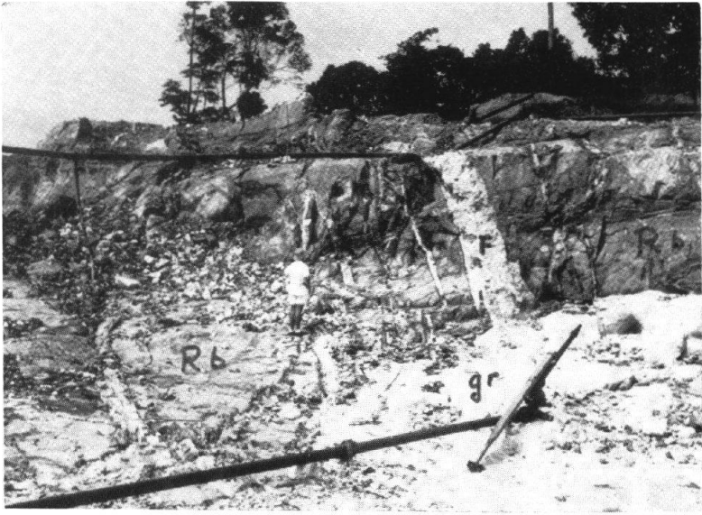
Photographie 7. — Zaïre, Maniema. Climat équatorial, chaud et humide, avec couverture du sol par la grande forêt. En dessous d'une couche d'éluvions de 2 à 3 mètres d'épaisseur, on exploite le bed-rock altéré sur plus de 15 mètres d'épaisseur. (Gr: granites, F: filon de quartz partant des granites, Rb: dolérites altérées friables, pouvant être abattues par un jet d'eau.). Camp Salukwango, 1956.
