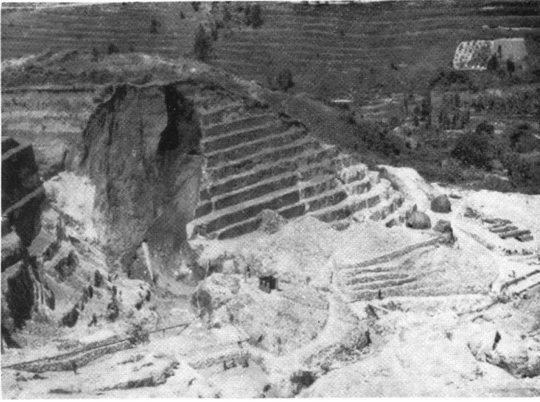
Photographie 13. — Rwanda, région de Katumba, pegmatites de Bijojo. La taille des hommes donne une idée de la hauteur de l'altération des pegmatites et des roches encaissantes: schistes et dolérites. Les terrains encaissants sont abattus hydrauliquement. 1953.
