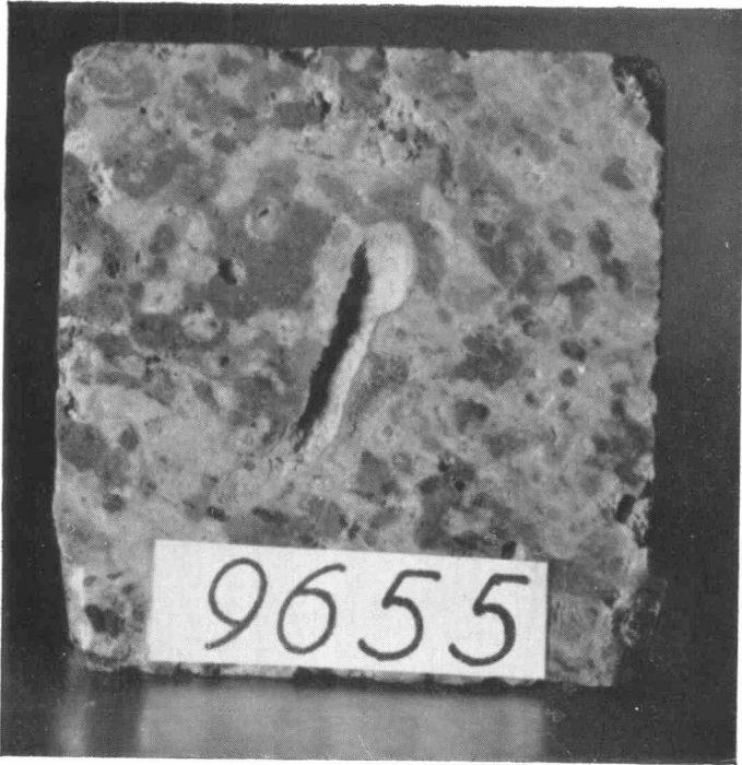
FIG. 8. — Latérite rocheuse manganésifère. Coupe (grandeur naturelle). (Photo : PAGE).
