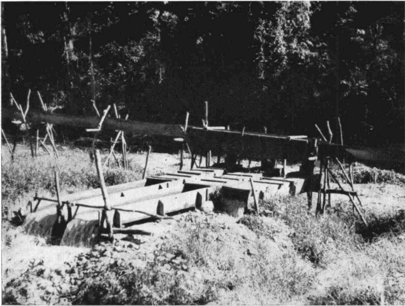
PHOTO 1. — Classeur à courant porteur et undercurrent (MGL-Congo, Division Lubushwa).
