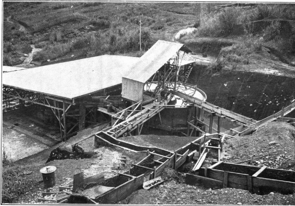
PHOTO N° 3. — Ensemble montrant un hydroséparateur Dorr en charge sur le circuit fermé Tube Mill-Dorr Classifier.
